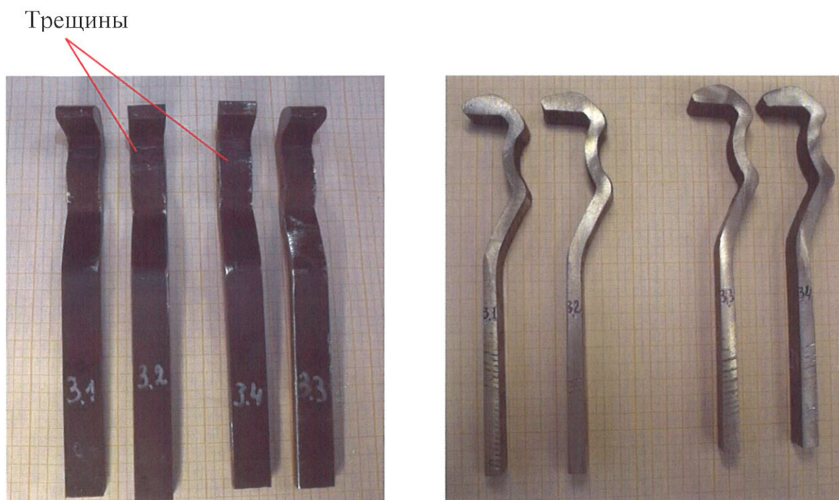
Рисунок 3.3.3 - Внешний вид образцов из шпунта SPU-VL после испытания
