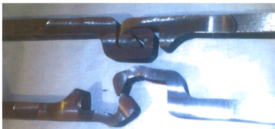
Рисунок 3.1.1 - Вид замка до и после испытаний
