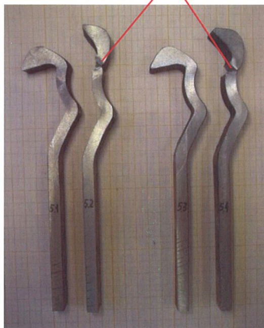
Рисунок 3.5 - Внешний вид образцов из шпунта ZU18 после испытания
