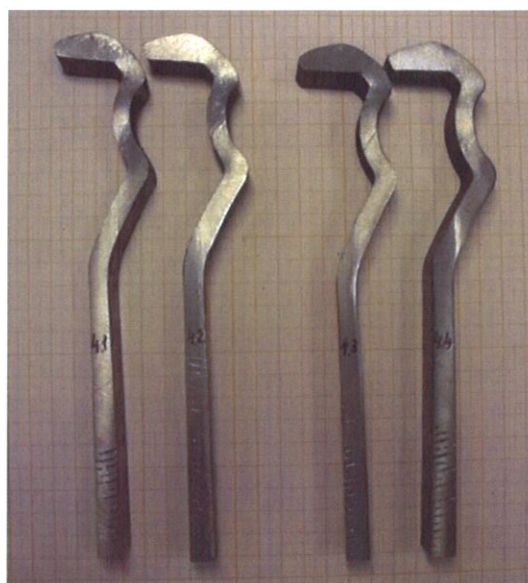
Рисунок 3.3.4 - Внешний вид образцов из шпунта SPU-III-VV после испытания
