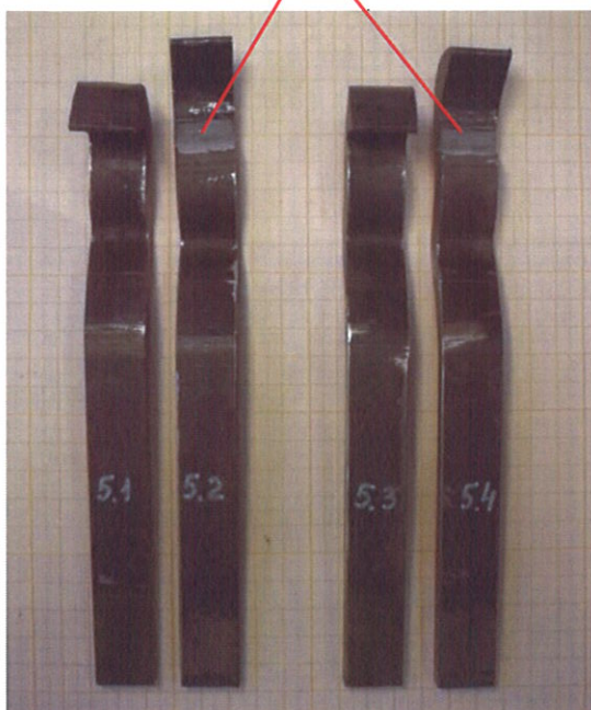
Рисунок 3.5 - Внешний вид образцов из шпунта ZU18 после испытания
