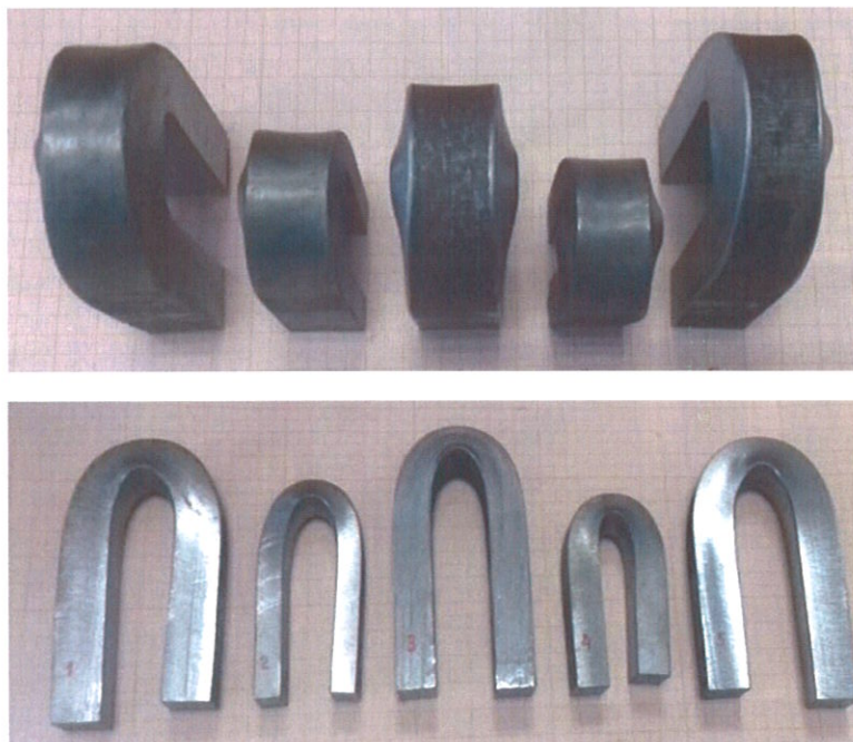
Рисунок 4.2.1- Внешний вид образцов после испытания на изгиб
